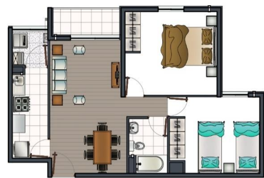
PLANTA DEPTO VUL_53 (2D-1B): 54,75 m2 ESCALA 1/50
