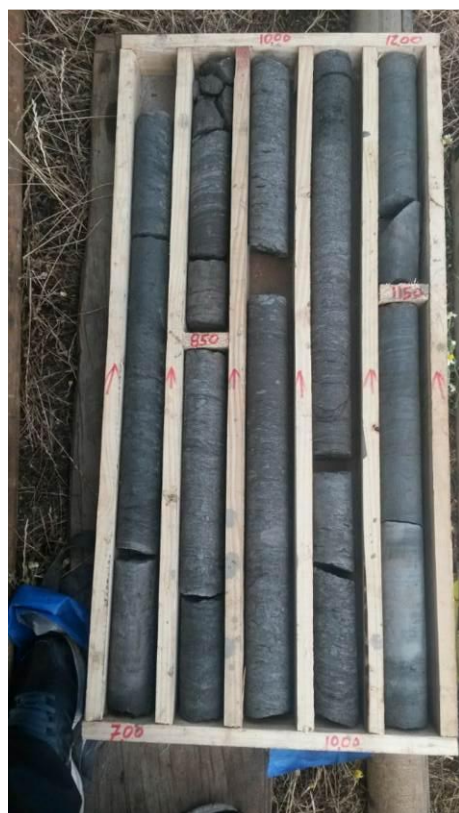
Figura 4.5: Caja con testigos extraídos de sondaje SPT-1, desde 7.5 m (arenisca y limolita)
