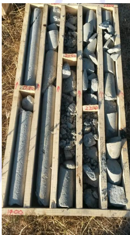
Figura 4.5: Caja con testigos extraídos de sondaje SPT-1, desde 7.5 m (arenisca y limolita)
