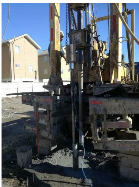
Figura 4.14: Ejecución de sondaje SPT-6 y medición de energía
