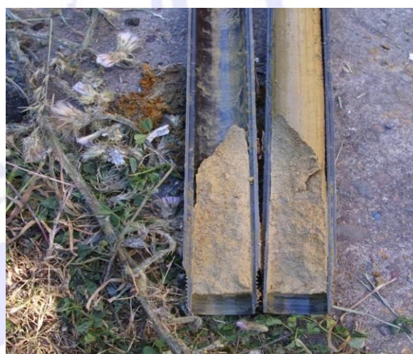
Figura 4.40: Ejecución de sondaje SPT-19 de 16 m de profundidad (2011)
