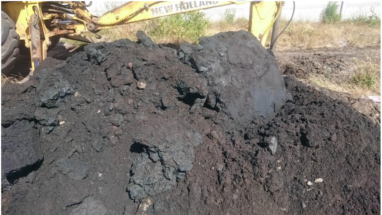
Figura 4.25: Ejecución de calicata C-6. Se detecta estrato de limo con restos orgánicos descompuestos entre 1.57 a 1.78 m
