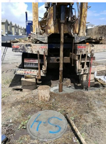
Figura 4.14: Ejecución de sondaje SPT-6 y medición de energía
