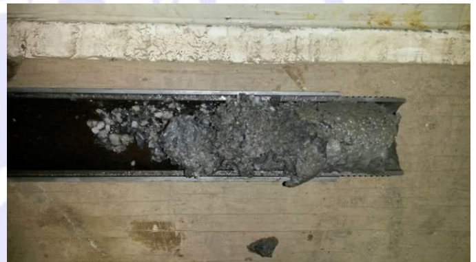
Figura 4.13: Muestra M-3 extraída mediante cuchara normal a 3.56 m de profundidad
