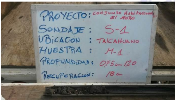
Figura 4.3: Muestra M-1 extraída mediante cuchara normal a 0.75 m de profundidad
