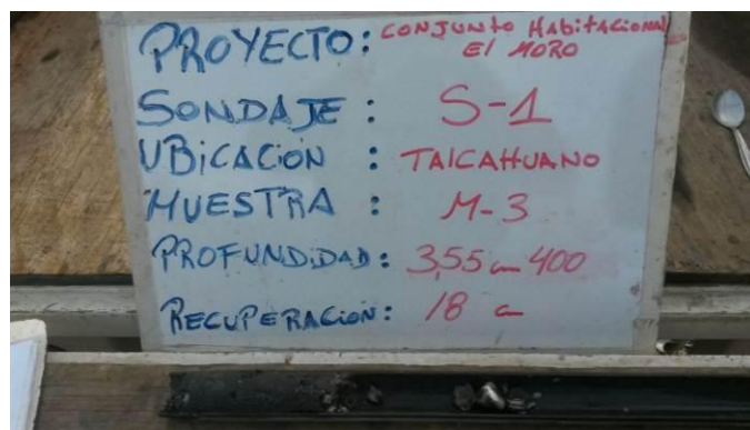
Figura 4.4: Muestras M-3 y M-6, extraídas mediante cuchara normal a 3.55 y 6.55 m de profundidad
