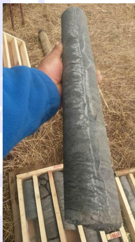
Figura 4.5: Caja con testigos extraídos de sondaje SPT-1, desde 7.5 m (arenisca y limolita)
