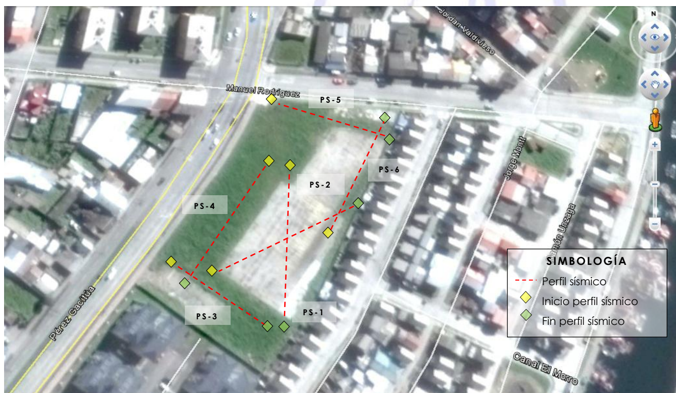
Figura 4.31: Ubicación de perfiles sísmicos ensayo ReMi
