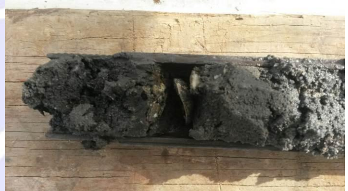
Figura 4.3: Muestra M-1 extraída mediante cuchara normal a 0.75 m de profundidad
