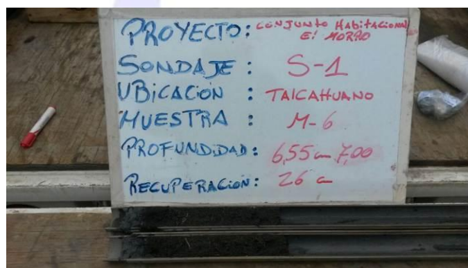
Figura 4.4: Muestras M-3 y M-6, extraídas mediante cuchara normal a 3.55 y 6.55 m de profundidad
