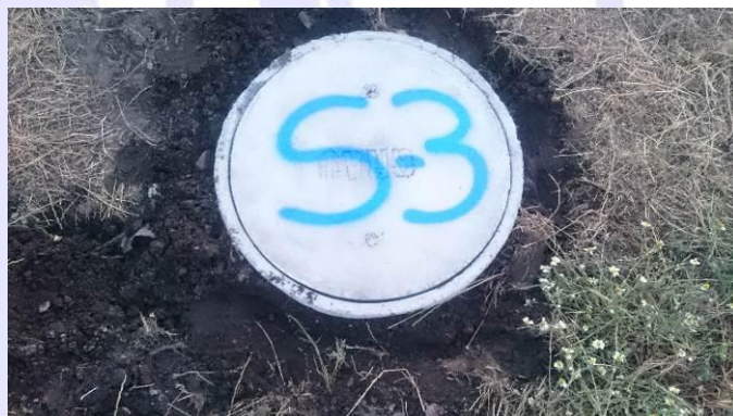
Figura 4.17: Cámaras de inspección para nivel freático en sondajes SPT-2 y SPT-3
