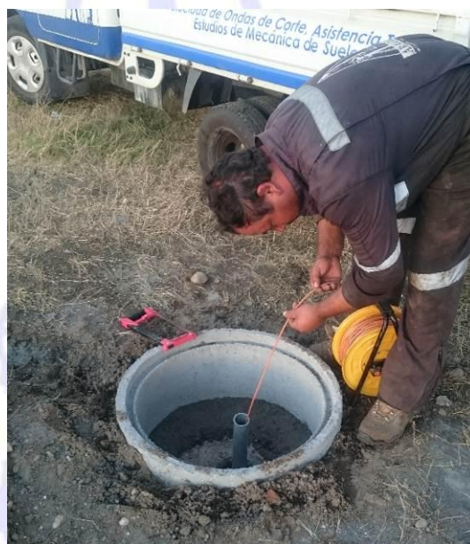
Figura 4.16: Medición del nivel freático en sondaje SPT-1
