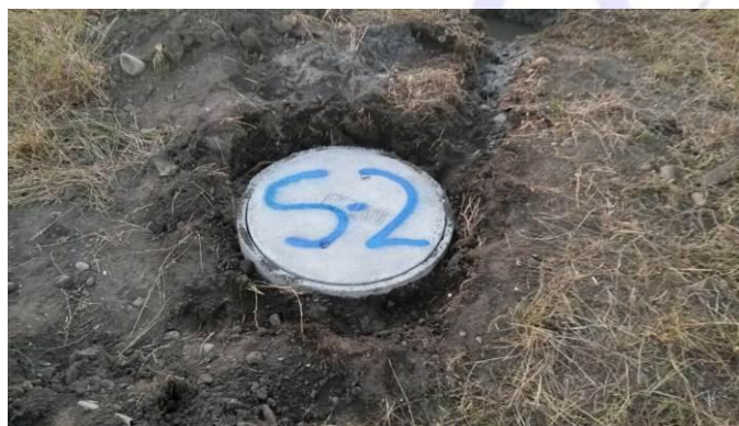
Figura 4.17: Cámaras de inspección para nivel freático en sondajes SPT-2 y SPT-3
