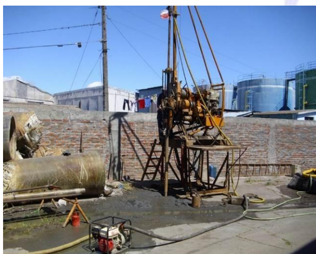
Figura 4.40: Ejecución de sondaje SPT-19 de 16 m de profundidad (2011)
