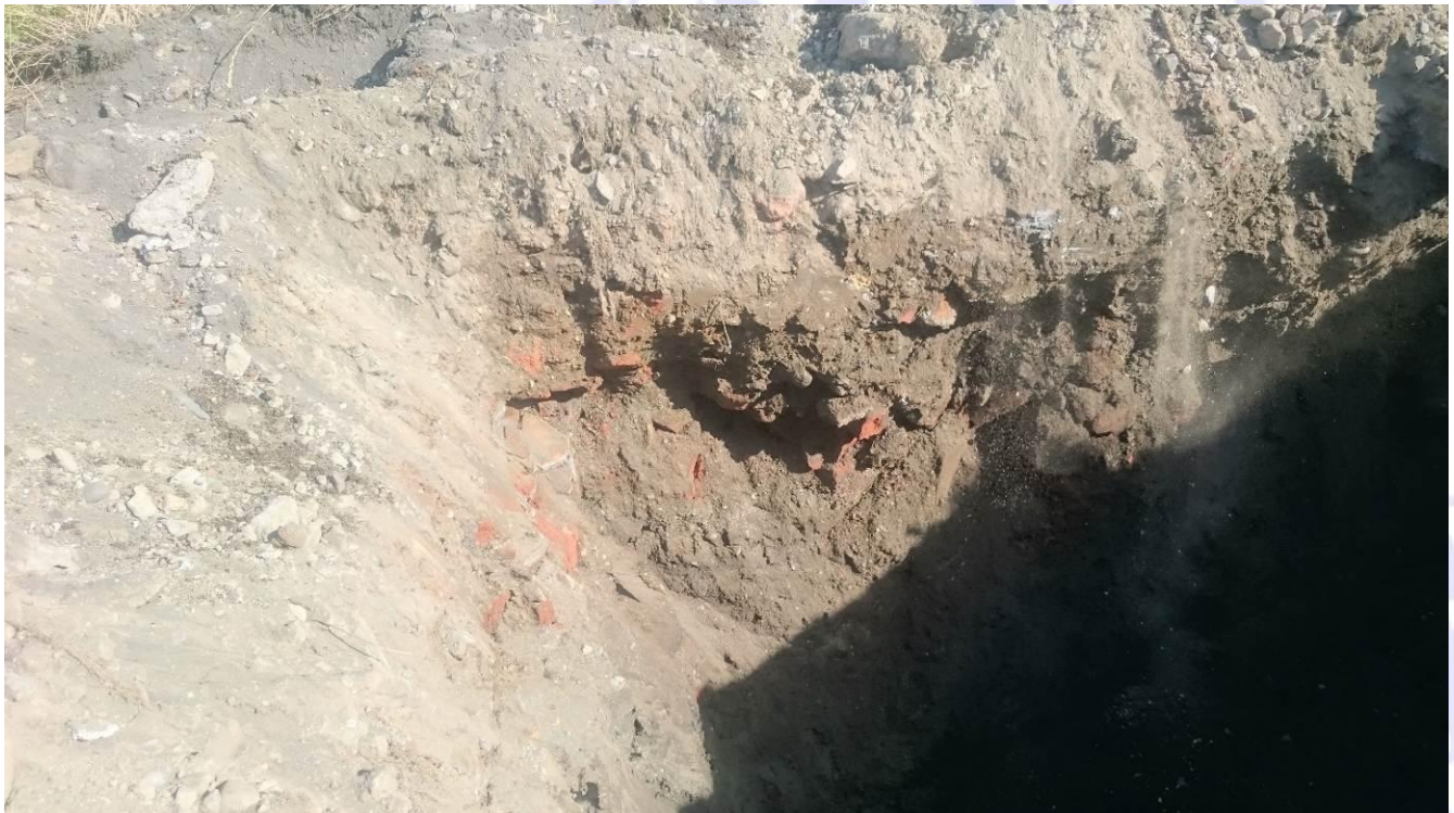
Figura 4.30: Rellenos artificiales en calicata C-16, hasta 2.5 m de profundidad
