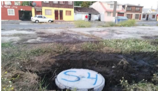
Figura 4.18: Cámaras de inspección para nivel freático en sondajes SPT-4 y SPT-5
